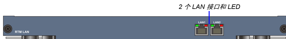
图 1-13 RMX 4000 RTM LAN 后面板布局
